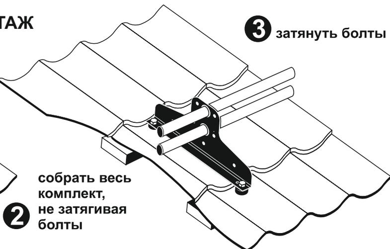
НЕСОБЛЮДЕНИЕ ПОСЛЕДОВАТЕЛЬНОСТИ МОНТАЖА МОЖЕТ ПРИВЕСТИ К ПОВРЕЖДЕНИЮ ПОКРЫТИЯ ТРУБ
